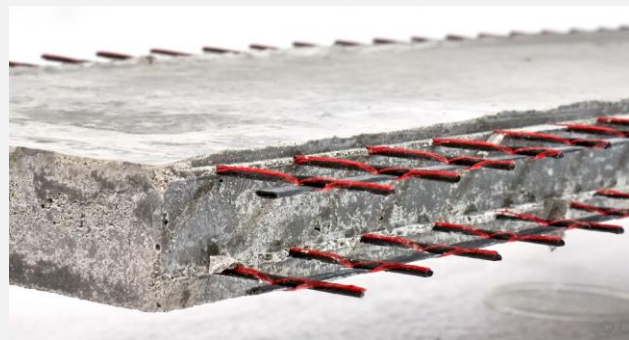
Rys. 1 Warstwa TRC w panelu typu TRC-FC
